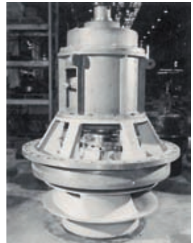
Модульная конструкция обеспечивает быстрый доступ к гидравлической части насоса без необходимости отсоединения патрубка.
